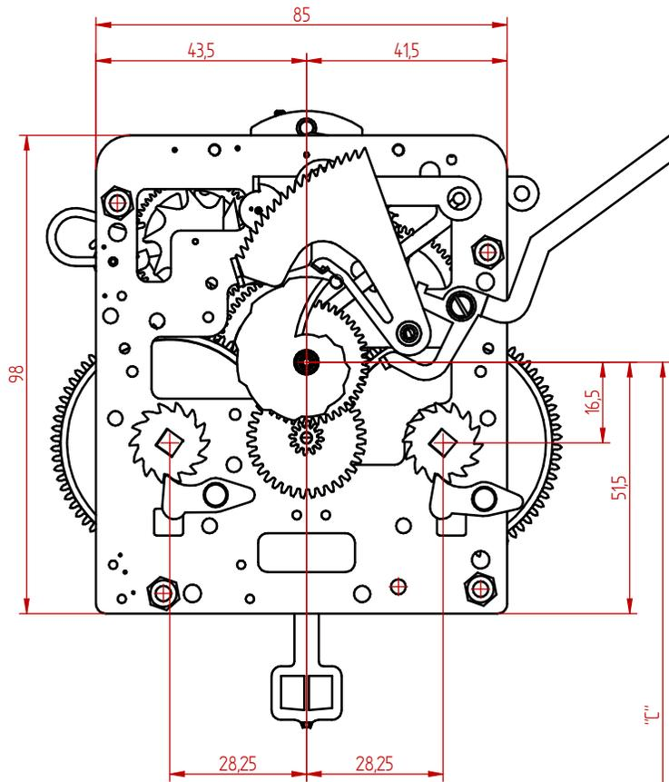
Die genauen Masse der verschiedenen Pendellängen u.s.w. sind aus der Pendelliste zu entnehmen
